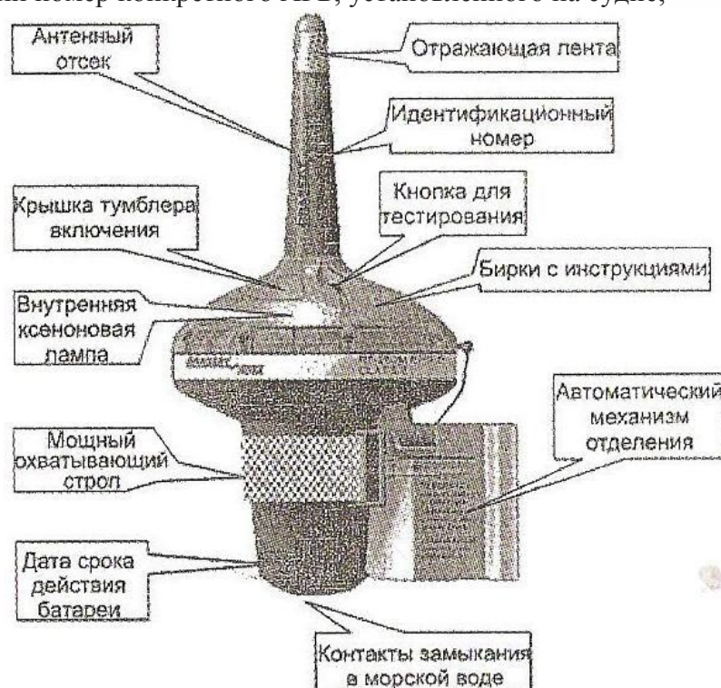
Рисунок 1 - Устройство АРБ-406 типа 260RT с механизмом крепления.
